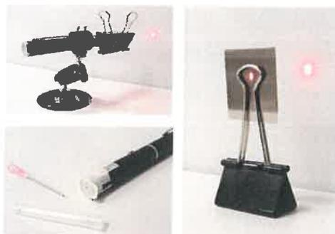
Fig. 19: O laser é mantido ligado usando um clip grande. Para reduzir o diâmetro do feixe, use fita adesiva e uma agulha. Uma película translúcida num suporte (clip grande) é usada para reduzir a intensidade do laser.
